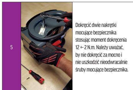
Dokręcić dwie nakrętki mocujące bezpiecznika stosując moment dokręcenia 12 + 2 N.m. Należy uważać, by nie dokręcić za mocno i nie uszkodzić nieodwracalnie śrub mocujące bezpiecznika.
