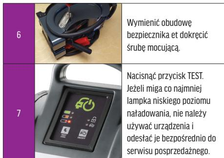
Wymienić obudowę bezpiecznika et dokręcić śrubę mocującą.
